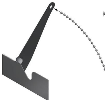
Kette in Kettenschloss einsetzen
